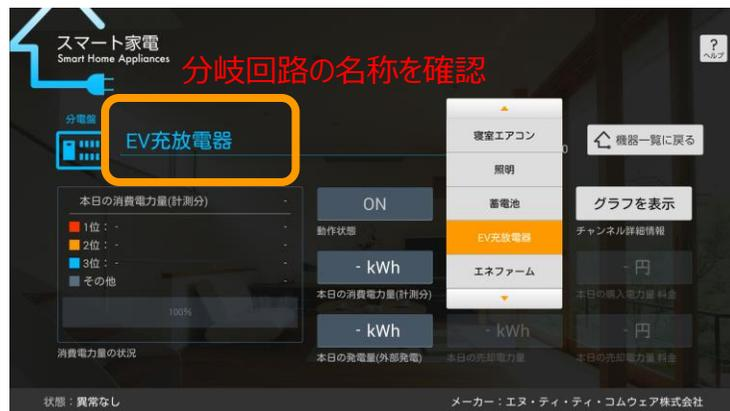
【手順3】手順1と手順2で確認した名称が異なる場合、完全に一致させるよう名称を再設定してください。このとき、両者の名称が一致していれば分岐回路の名称を変更しても、充放電スタンドアイコンのニックネームを変更しても構いません。名称を完全一致させることで、分岐回路での計測値を集計対象から除外することができます。
