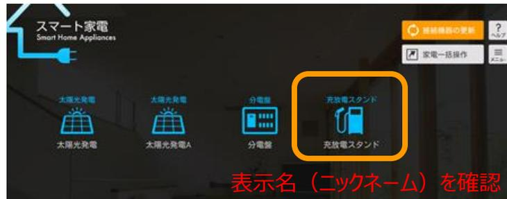
【手順2】V.電力量集計のための設定手順（分岐回路の名称設定）で設定した分電盤のアイコンを選択し、充放電スタンドが接続されている分岐回路に設定された名称を確認してください。
