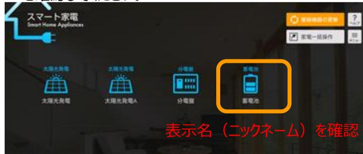
【手順2】V.電力量集計のための設定手順（分岐回路の名称設定）で設定した分電盤のアイコンを選択し、蓄電池が接続されている分岐回路に設定された名称を確認してください。
