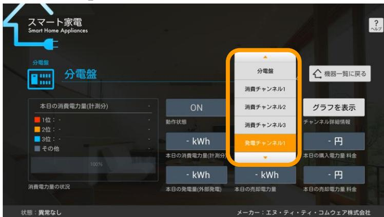
【手順5】手順2でメモした内容を参考に各センサで計測している分岐回路の名称を設定してください。電力量レポートアプリでは分岐回路の名称に特定のキーワードが含まれるかどうかによって、その分岐回路を集を対象とするか否かを判断します。そのため、VI.分岐回路名称設定ルール（P.15）の表にしたがって名称を設定してください。
