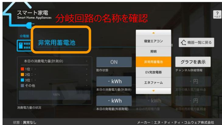
【手順3】手順1と手順2で確認した名称が異なる場合、完全に一致させるよう名称を再設定してください。このとき、両者の名称が一致していれば分岐回路の名称を変更しても、蓄電池アイコンのニックネームを変更しても構いません。名称を完全一致させることで、分岐回路での計測値を集計対象から除外することができます。
