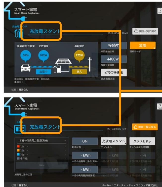
充放電スタンドのアイコンと分電盤の分岐回路に表示されているニックネームを同一のものに設定する。
