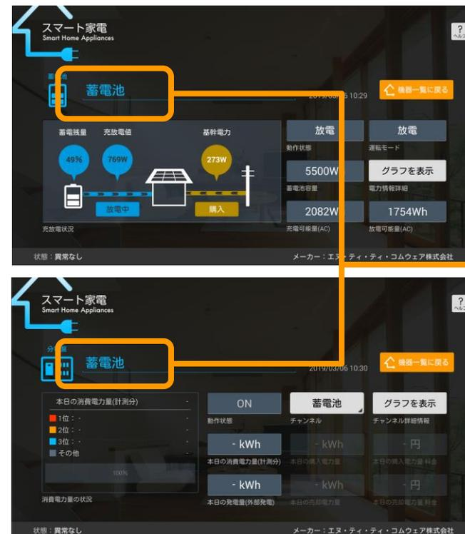
蓄電池のアイコンと分電盤の分岐回路に表示されているニックネームを同一のものに設定する。
